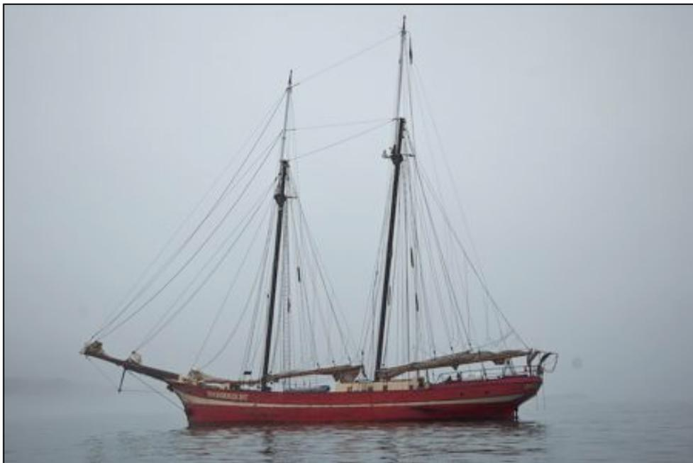
Die *Noorderlicht* ist ein Zweimastsegler, gebaut 1910 in Flensburg und für längere Zeit unter dem Namen *Kalkgrund* als Feuerschiff in der Ostsee gefahren. Seit 1991 ist die *Noorderlicht* in holländischem Besitz und wurde nach holländischen Bestimmungen umgebaut. Die *Noorderlicht* ist 46 m lang, 6,5 m breit und fährt in Binnengewässern genauso wie auf allen Weltmeeren.
