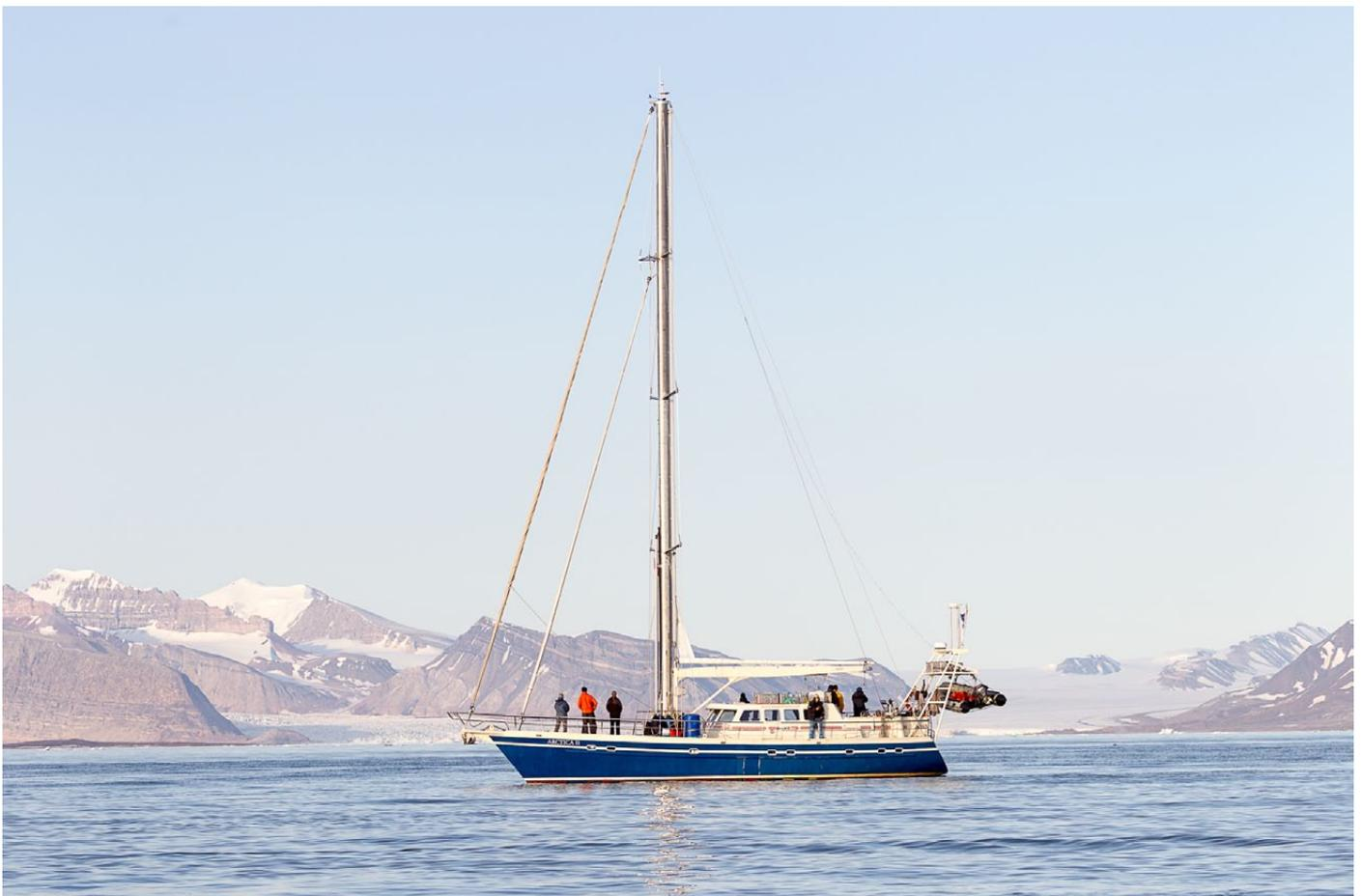
*Die 62 Fuß (19,1 Meter) Segelyacht Arctica II, gebaut 2003, hat einen kräftigen Rumpf aus Stahl, 3 Segel mit insgesamt 216 Quadratmeter Fläche und einen 210 PS Motor. Sie hat 5 Kabinen mit insgesamt 13 Kojen und kann dank großzügig bemessener Tanks, Stauräume und Wassermacher einige Wochen lang unabhängig operieren.*
