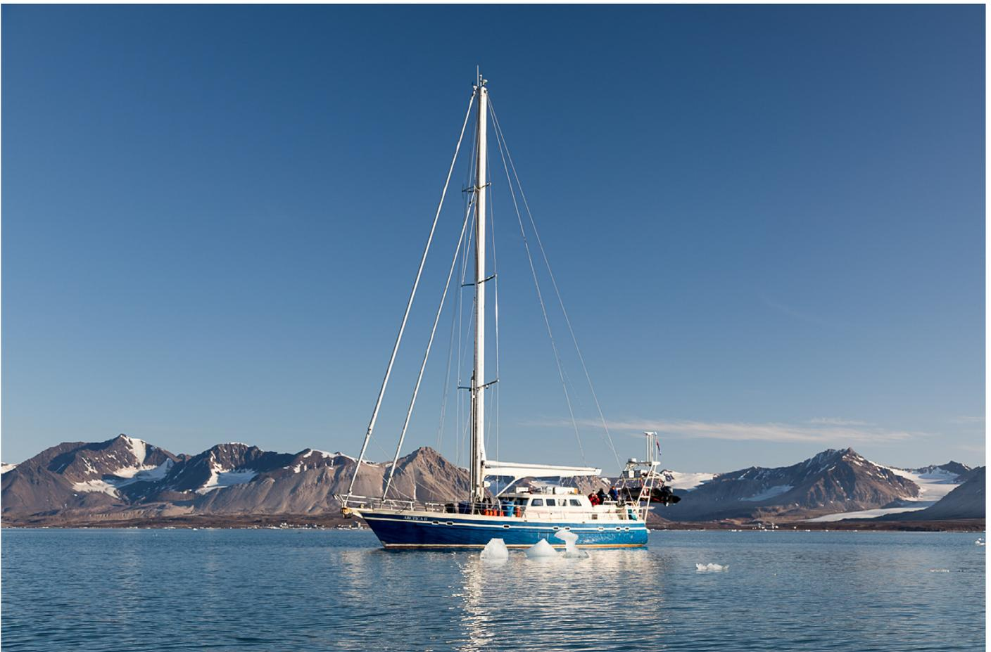
*Die 62 Fuß (19,1 Meter) Segelyacht Arctica II, gebaut 2003, hat einen kräftigen Rumpf aus Stahl, 3 Segel mit insgesamt 216 Quadratmeter Fläche und einen 210 PS Motor. Sie hat 5 Kabinen mit insgesamt 14 Kojen und kann dank großzügig bemessener Tanks, Stauräume und Wasseraufbereitungsanlage mehrere Wochen lang unabhängig operieren.*
